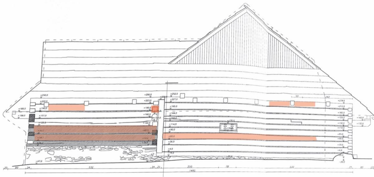
Rys. 3. Ściana zachodnia. Kolorem czerwonym zaznaczono elementy z śladami korozji biologicznej ze strony owadów szkodników drewna.
